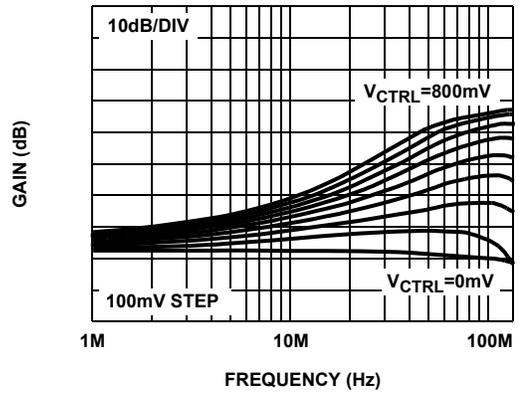
FIGURE 8. GAIN AS THE FUNCTION OF  $V_{CTRL}$
