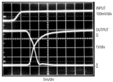
MAX912/MAX913 RESPONSE TO 50MHz (±10mVp.p) SINE WAVE
