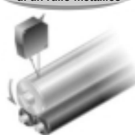
Rilevamento eccentricità di un rullo metallico
