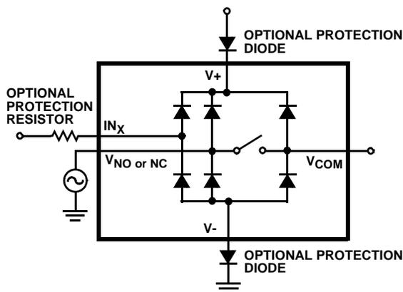
FIGURE 8. OVERVOLTAGE PROTECTION
