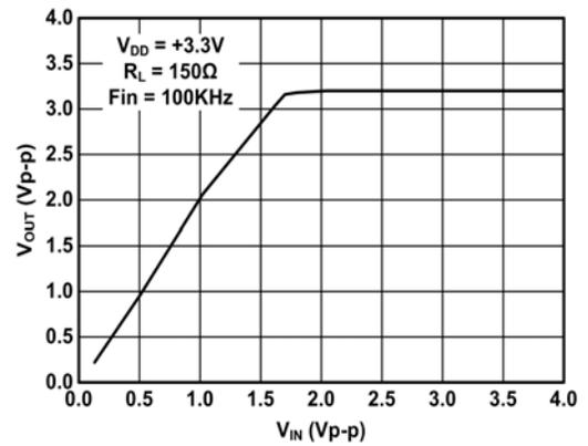
FIGURE 6. MAXIMUM OUTPUT MAGNITUDE vs INPUT MAGNITUDE
