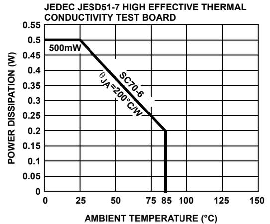
FIGURE 23. PACKAGE POWER DISSIPATION vs AMBIENT TEMPERATURE
