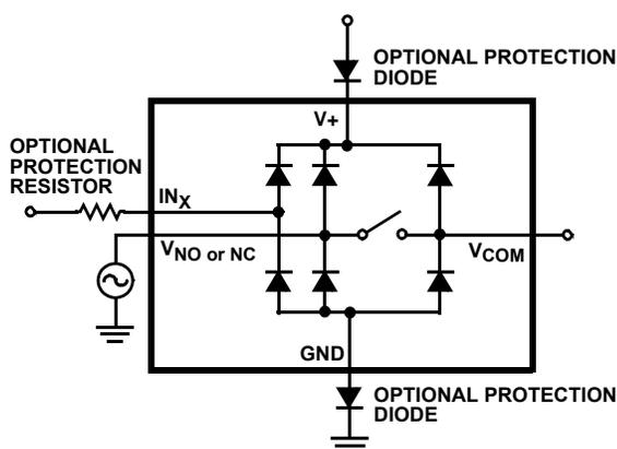
FIGURE 8. OVERVOLTAGE PROTECTION
