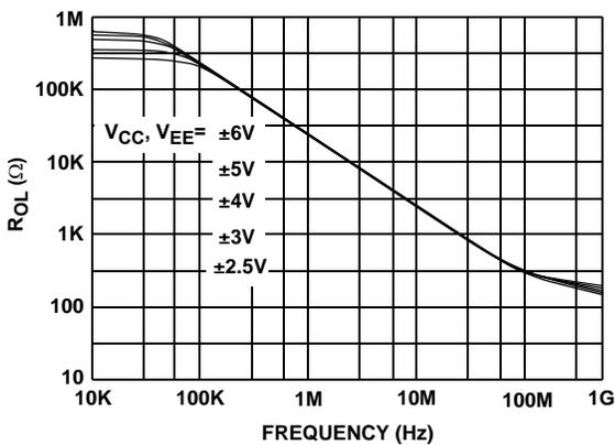
FIGURE 11.  $R_{OL}$  FOR VARIOUS  $V_{CC}$ ,  $V_{EE}$
