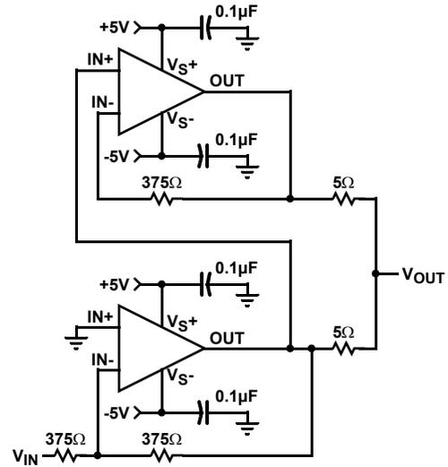
FIGURE 23. INVERTING 200mA OUTPUT CURRENT DISTRIBUTION AMPLIFIER
