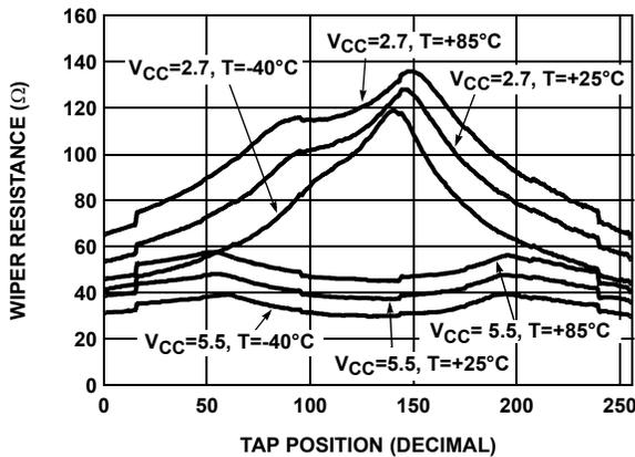
FIGURE 1. WIPER RESISTANCE vs TAP POSITION
