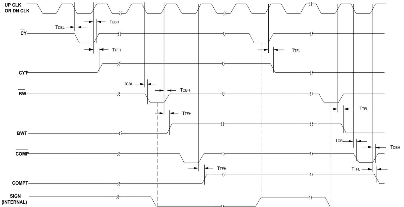
**FIGURE 3. CLOCK TO  $\overline{\text{CY}}$ / $\overline{\text{BW}}$  OUTPUT PROPAGATION DELAYS**
