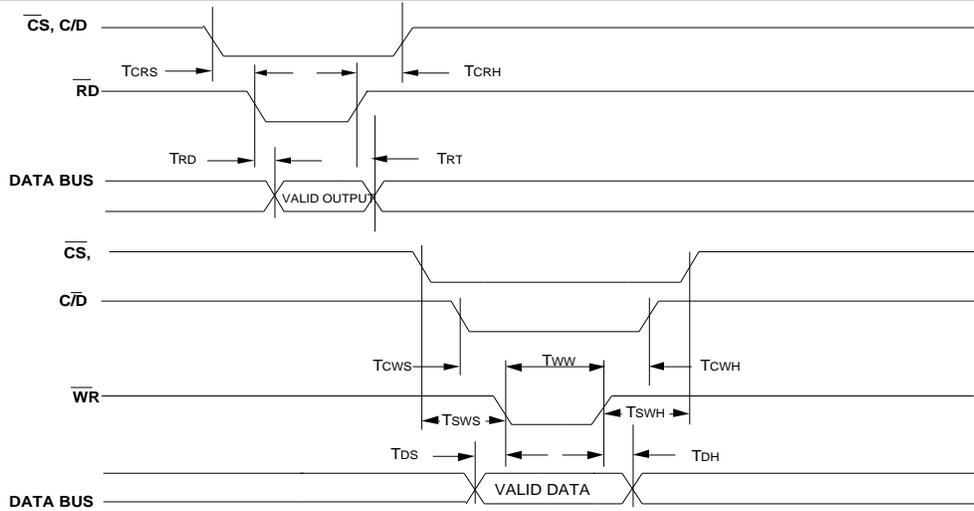
FIGURE 4. READ/WRITE CYCLES
