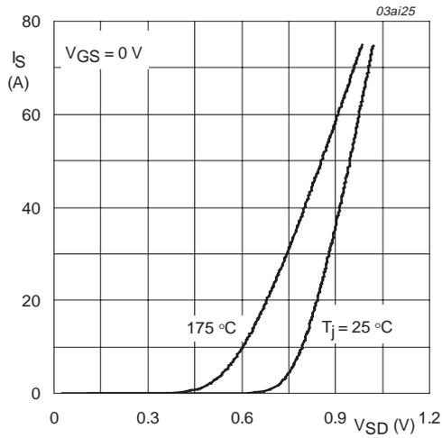
$T_j = 25\text{ }^\circ\text{C}$  and  $175\text{ }^\circ\text{C}$ ;  $V_{GS} = 0\text{ V}$
