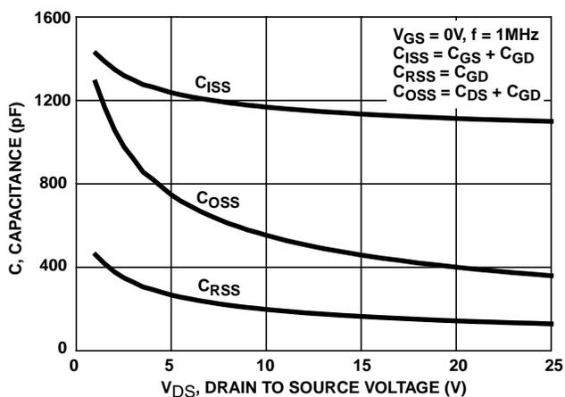
FIGURE 12. CAPACITANCE vs DRAIN TO SOURCE VOLTAGE
