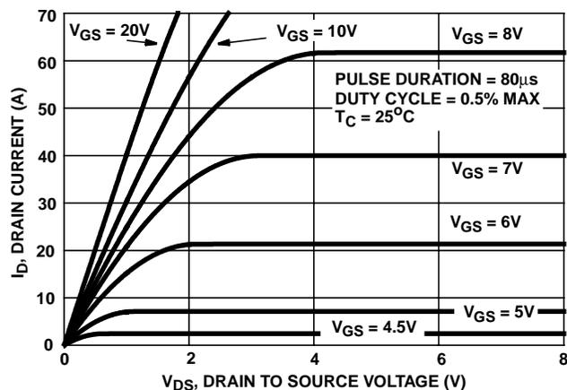
FIGURE 7. SATURATION CHARACTERISTICS
