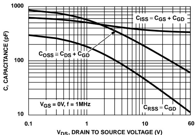
FIGURE 14. CAPACITANCE vs DRAIN TO SOURCE VOLTAGE
