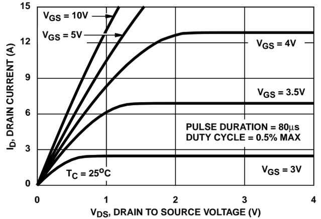
FIGURE 7. SATURATION CHARACTERISTICS
