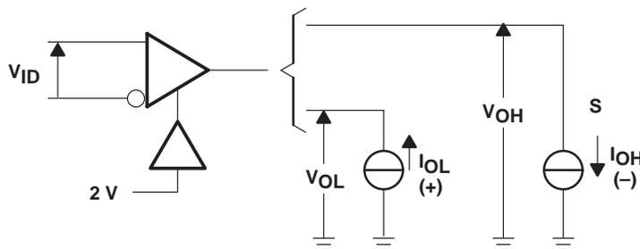
Figure 1.  $V_{OH}$ ,  $V_{OL}$
