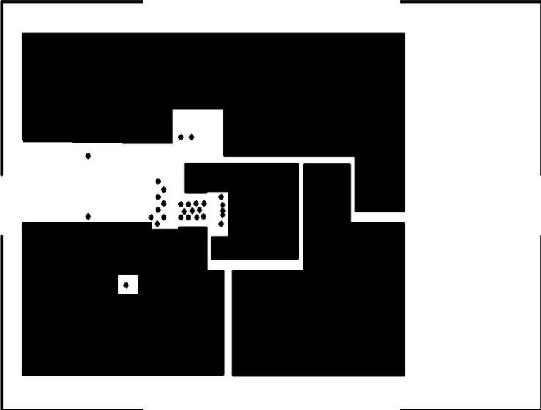
Figure 28. SP7652EB PC Layout 3<sup>rd</sup> Layer Side
