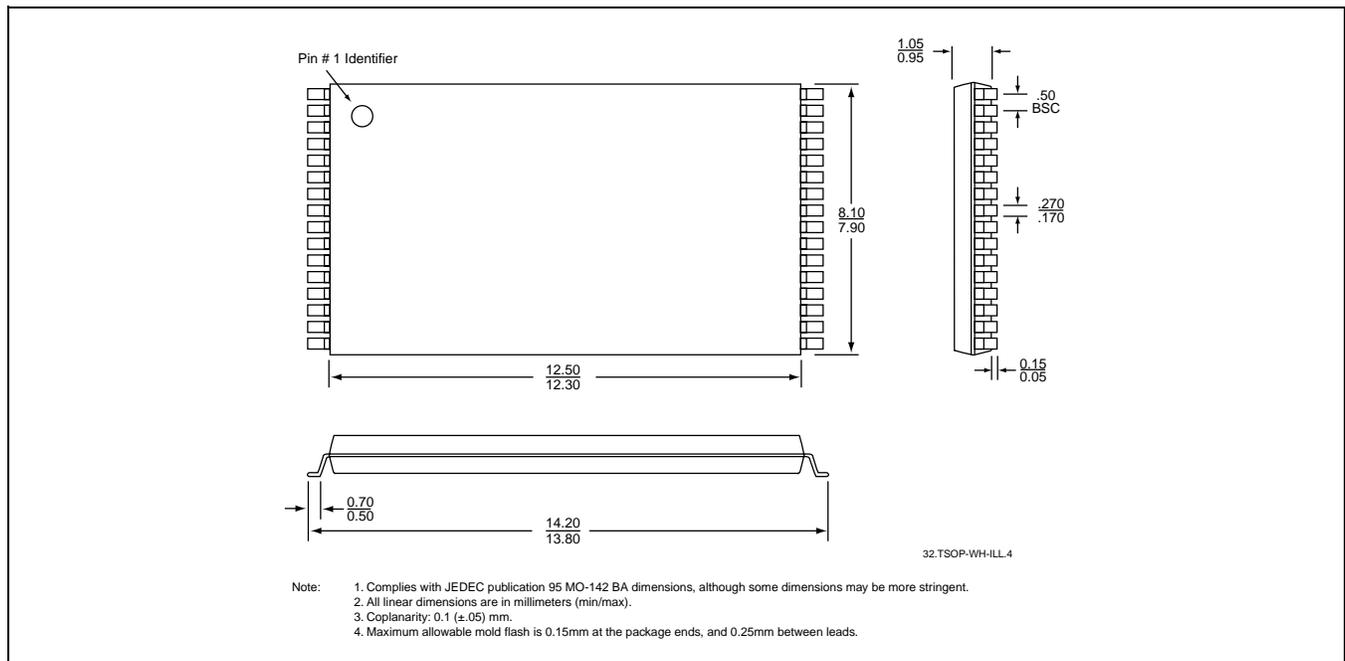
**32-PIN THIN SMALL OUTLINE PACKAGE (TSOP) 8MM X 14MM**
