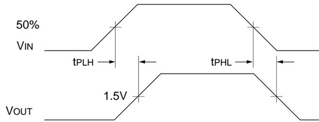
**ECL/TTL WAVEFORMS: RISE AND FALL TIMES**
