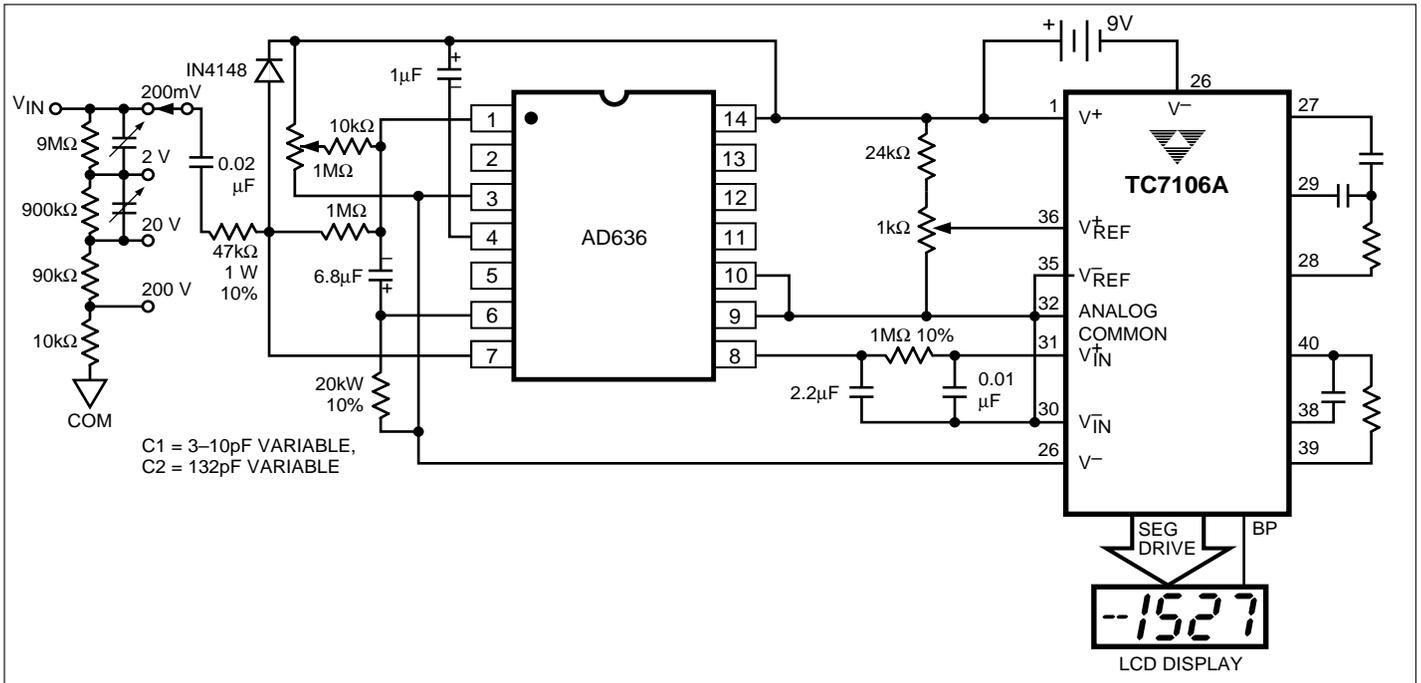
Figure 18. 3 1/2 Digit True RMS AC DMM
