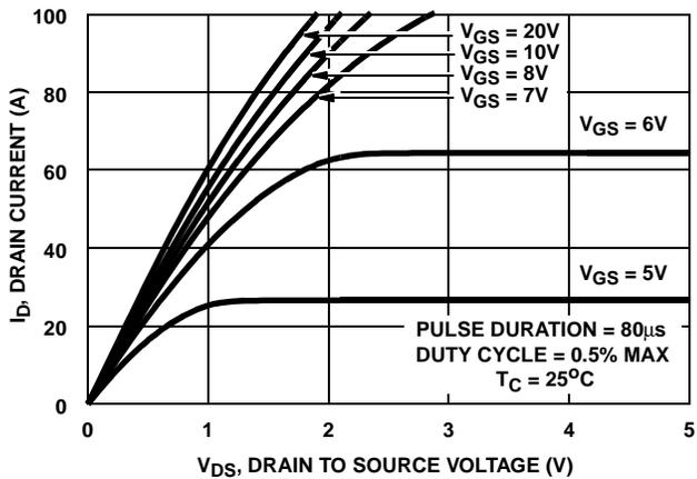
FIGURE 7. SATURATION CHARACTERISTICS
