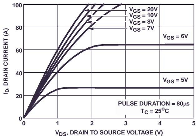
FIGURE 7. SATURATION CHARACTERISTICS
