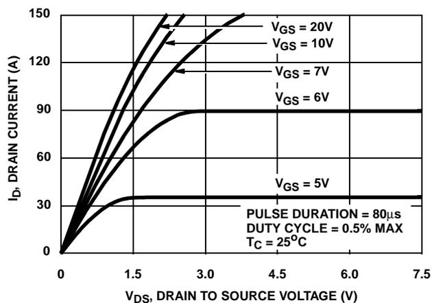
FIGURE 7. SATURATION CHARACTERISTICS
