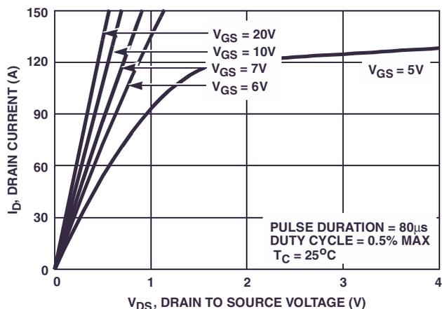
FIGURE 7. SATURATION CHARACTERISTICS
