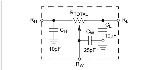
**EQUIVALENT A.C. LOAD CIRCUIT**
