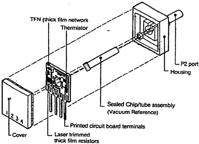
**Pressure Sensors** 136PC15A2L 136PC15A2L 136PC15A2L
