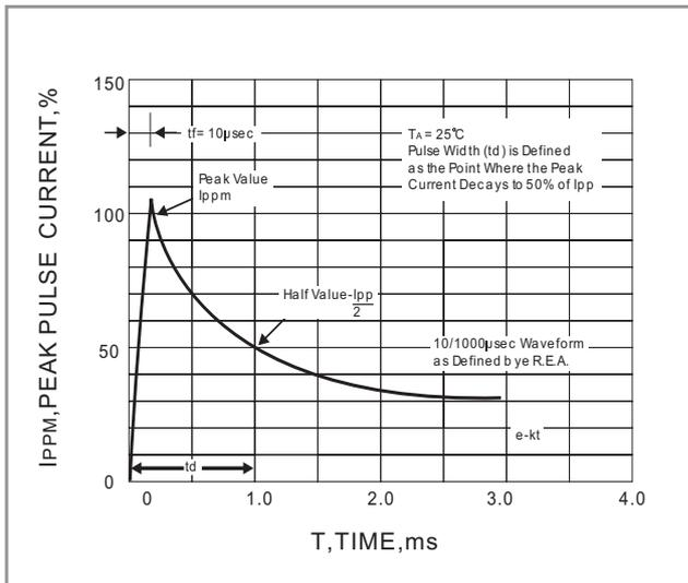
Fig.3 PULSE WAVEFORM
