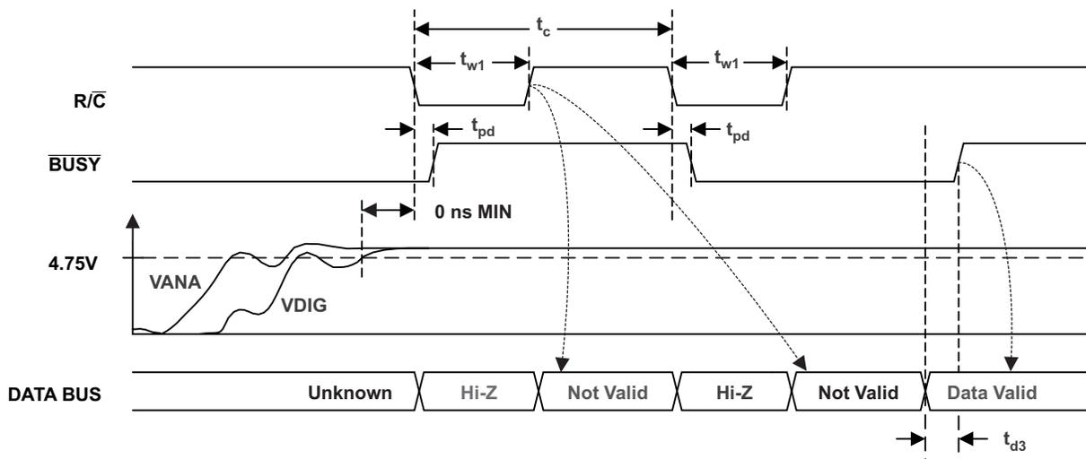
Figure 26. ADC Reset
