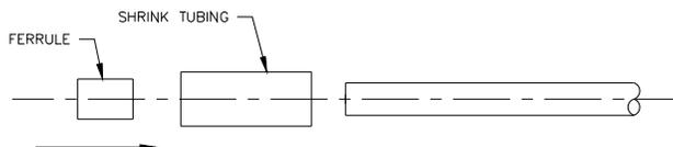
3. STRIP CABLE JACKET, BRAID AND DIELECTRIC TO SPECIFICATION LENGTHS.
